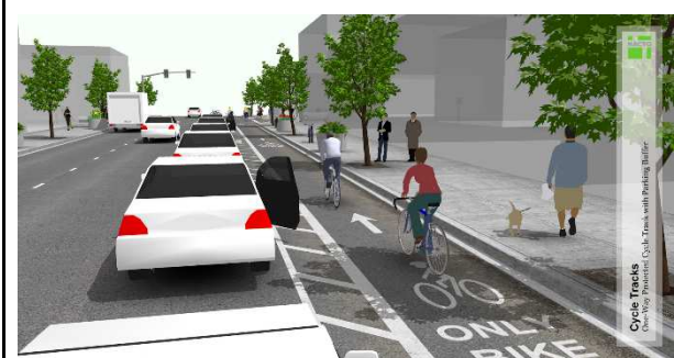
Piste unidirectionnelle sur chaussée avec zone tampon et protégée par des véhicules stationnés.
